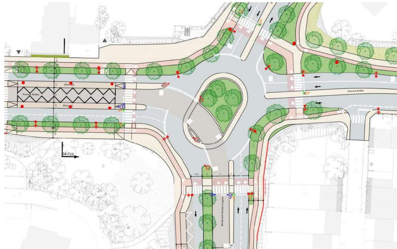
Figure 53 : Insertion du giratoire des 4 pentes
