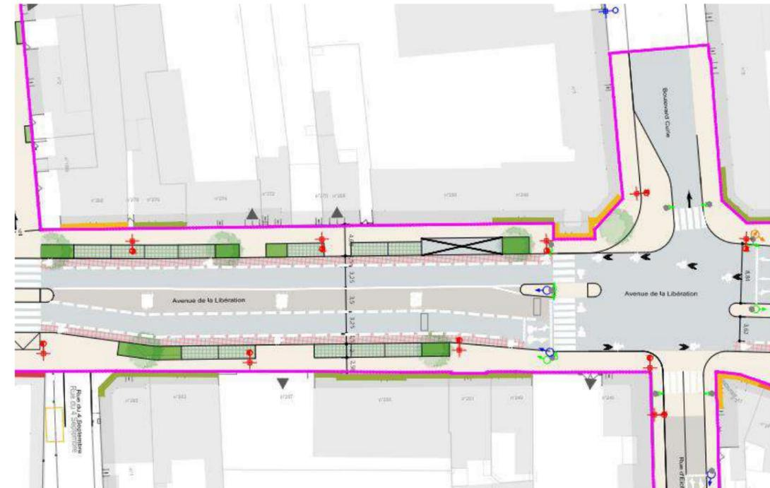
Figure 19 : Plan d’insertion : couloir d’approche
