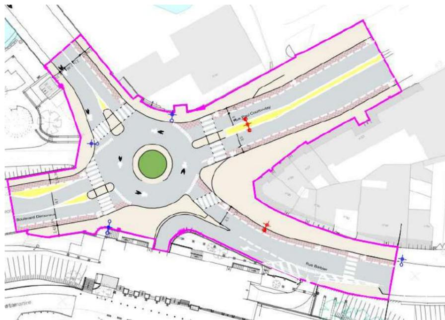
Figure 22 : Plan d'insertion du giratoire Demorieux/Courboulay
